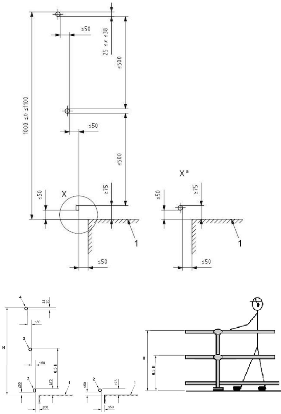
Figura 3: Sistema de proteção contra quedas em plataforma. (dimensões em milímetros)
